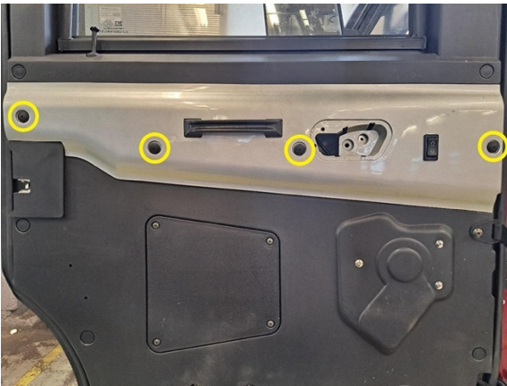
Irrota oven paneelin kiinnitysklipsut.
