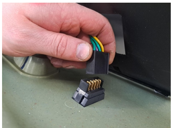
Irrota lasin nostinkytkimen liitin.
