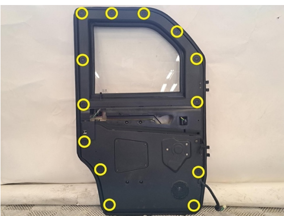
Irrota kiinnitysruuviin suojakorkit. (pieni talttameisseli).
