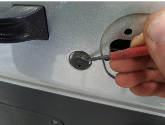
Raota kiinnitysklipsua (pieni talttameisseli) ja irrota kiinnitysklipsu. (muovinen sorkkarauta).
